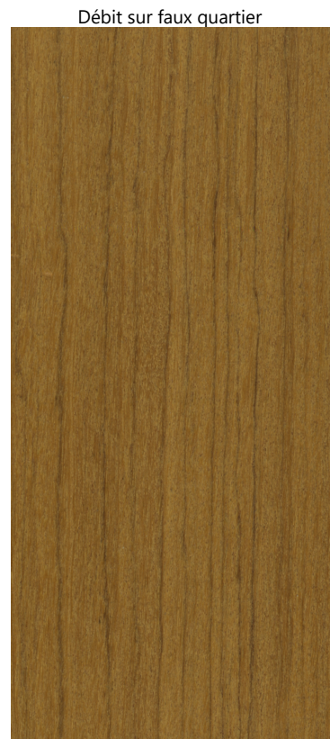
Débit sur faux quartier
